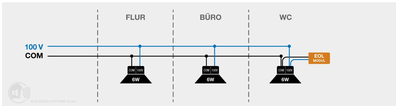
Bei den unterschiedlichen Systemen ist ein EOL-Modul für die Linienüberwachung notwendig (VARES-1500/2000) bzw. optional (VARES-1000/3000).
