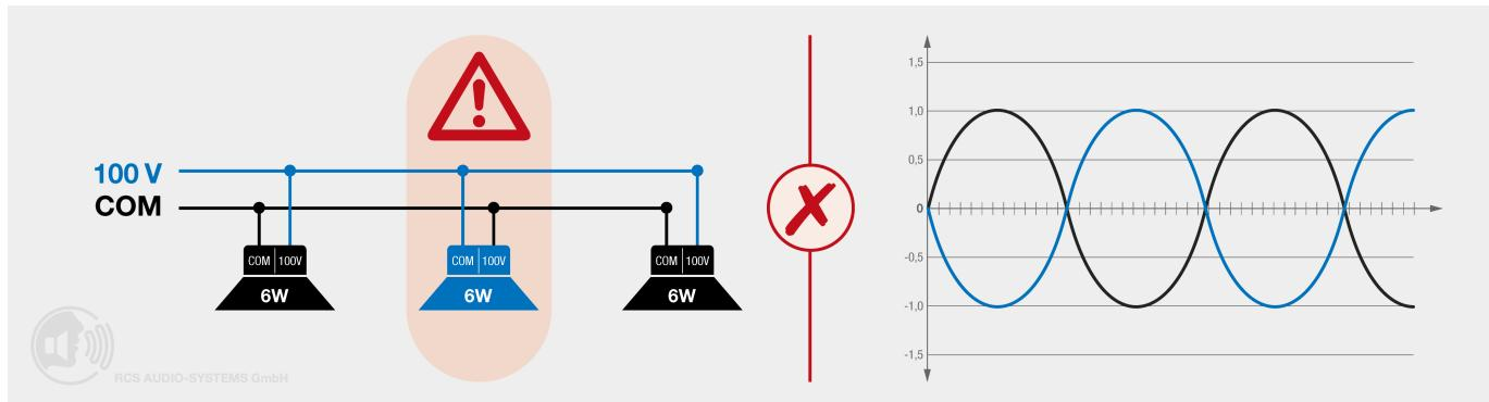
Werden die Lautsprecher nicht phasengleich angeschlossen, kommt es Phasenauslöschen.
